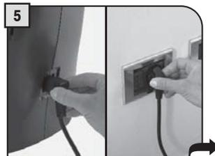
5 Introducir el enchufe en la toma situada en la parte posterior de la máquina y el otro extremo en una toma de corriente adecuada.
